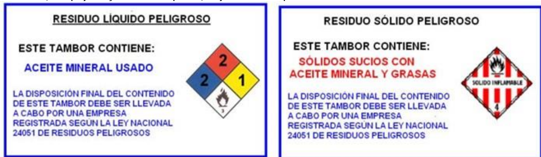
Rótulos recipientes con Residuos Especiales / Peligrosos líquidos y sólidos.
